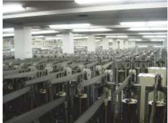
Fig. 1 Creep testing machines (NIMS Meguro Site).
