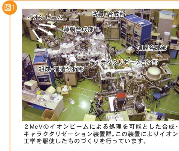
2 MeVのイオンビームによる処理を可能とした合成・キャラクタリゼーション装置群。この装置によりイオン工学を駆使したものづくりを行っています。
