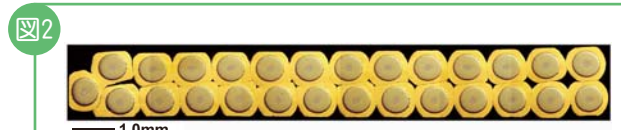
27本のNb 3 Al線材を編み込んだラザフォードケーブル。87%と高い充填率で圧縮成型されている。液体ヘリウム(4.2K)中で25,000A以上の大電流を通電することができる。今年の夏、米国フェルミ国立加速器研究所と共同で試作された。
