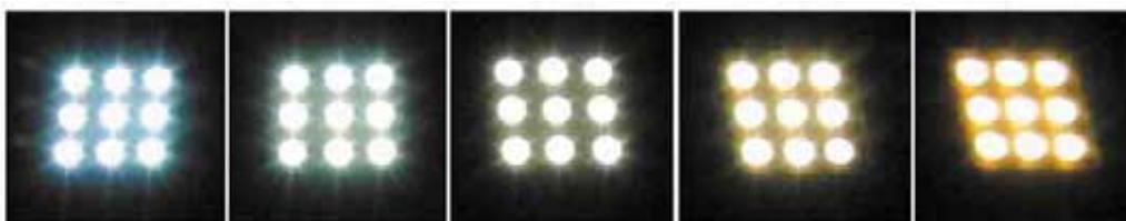
図2 開発した赤・緑・黄色蛍光体を用いた白色LED照明。
