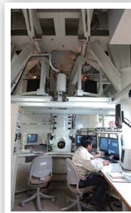
超高压電顕共用ステーション イオン注入その場観察 超高压電子顕微鏡
