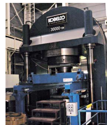
3万トン高圧合成装置。10GPa程度までの圧力範囲で大容量の高圧合成実験が可能。
