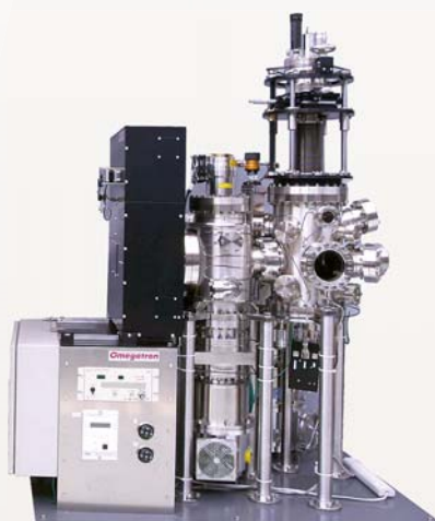
図2 スピン偏極低エネルギーイオン散乱分光装置のプロトタイプ He+イオンビーム: 偏極率~25%、エネルギー10eV~2keV、電流<100nAアナライザー: 角度分解静電半球形、2軸回転
