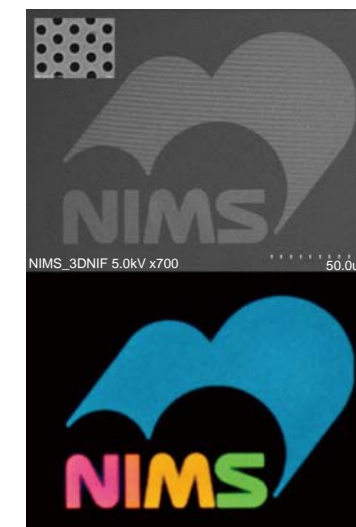
図2 試作した表面プラズモンカラーフィルタ 上:電子顕微鏡像 下:透過光像
