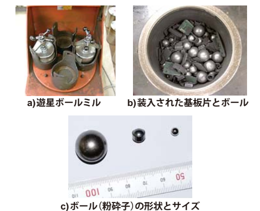
図2 実験に使ったボールミル(遊星ボールミル)中に硬質材料製のボール(右)を有する容器に、粗破砕した使用済み携帯電話をいれる。容器は遊星ボールミル装置(左)にセットされ、装置の中心軸の周りで回転(公転)するとともに、容器自体も回転(自転)する。
