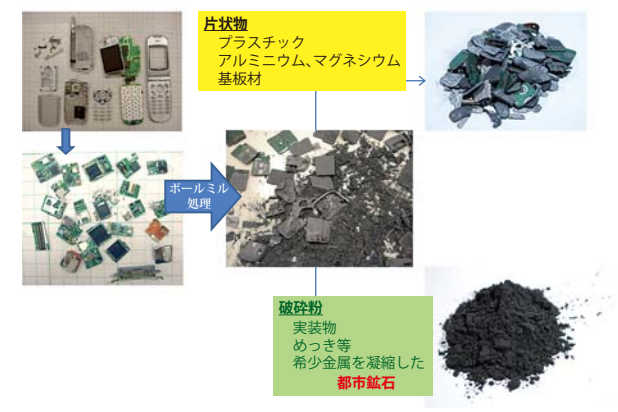
図1 処理工程の概略 ボールミルに入る程度に粗破砕した使用済み携帯電話(左)をボールミルで処理(中)。プラスチック、アルミニウム、基板材などは片状物のまま残留(右上)。基板上に実装されているLSIチップや部品などは優先的に剥離・粉碎され「都市鉱石」として濃化される(右下)。
