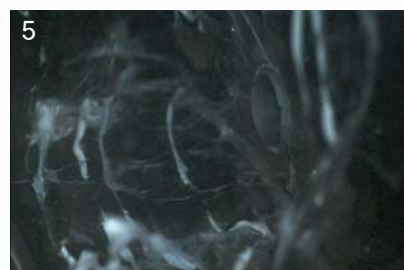
衝突による飛翔体(プラスチック部分)の破壊反跳
