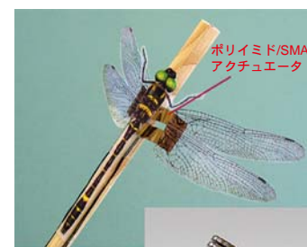
図3 ポリイミド/SMAアクチュエータで羽根を動かすトンボのおもちゃ
