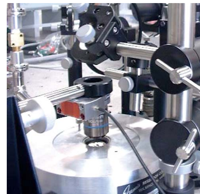
図2 顕微鏡分光装置の写真。手前の顕微鏡対物レンズの下、真空冷却器のガラス窓を挟んで試料が置かれている。
