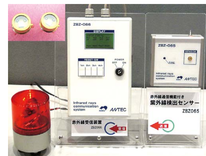
図2 ダイヤモンド太陽光ブライント紫外線センサを用いた火災検知システム
