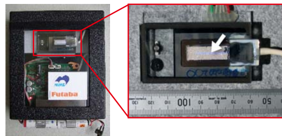
図2 乾電池駆動遠紫外光源: 拡大図は試作発光素子を示す。矢印で示した青い線が光出力部分。強力な遠紫外光とともに放出される弱い可視光成分(400nm)が青白く見えている。
