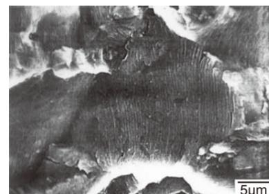
図2(b) 疲労破壊した部品のマイクロ破面観察で得られたストライエーション(日航ジャンボ機墜落事故)
