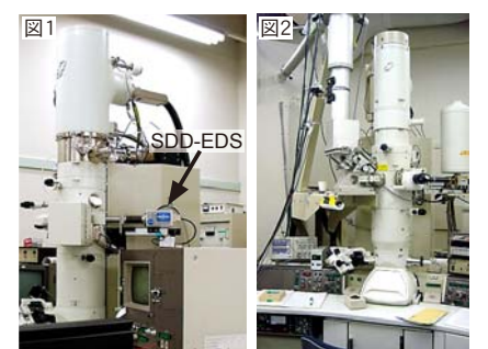
図1 JEOL JEM2010F + SDD-EDS 図2 JEOL JEM2010 + マイクロカロリメータEDS
