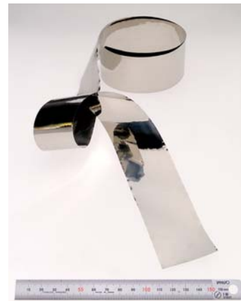
冷間圧延で作製した金属間化合物Ni 3 Al箔(厚さ23μm)
