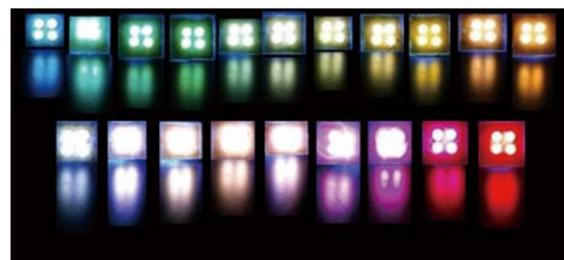
図2 電気泳動法によるサイアロン蛍光体粒子の膜実装例。ITOガラス上に積層した黄、緑、赤のサイアロン蛍光体を青色光で励起し、演色性の高い発光特性を実現しています。
