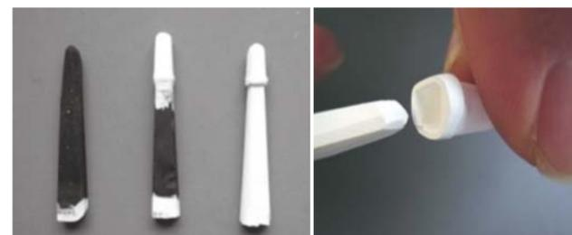
図1 形状加工した耐火物を導電性高分子(ポリピロール)で被覆し基材に直接使用した例。粒子堆積後に基材との一体焼成が可能で、歯冠材料など複雑形状部材の作製に適用可能な技術です。
