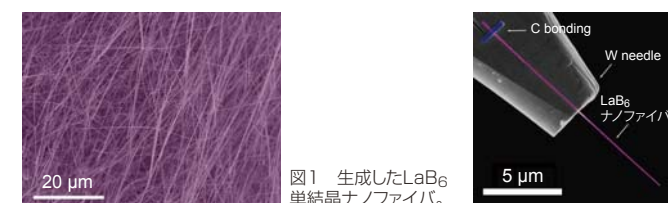
図2 LaB 6 単結晶ナノファイバをタングステン支持針に接合させ、作製した電子源
