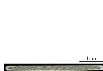
図5 NIMS Bi系高温超伝導テープ線材銀及び銀合金基材の中に、超伝導体(Bi,Pb) 2 Sr 2 Ca 2 Cu 3 O x のフィラメントが分散している
