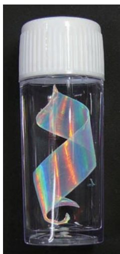
図2 高分子ゲル・マトリックスで固定化された人工オパール膜（コロイド結晶ゲル）。虹色の発色は光のBragg反射に起因する
