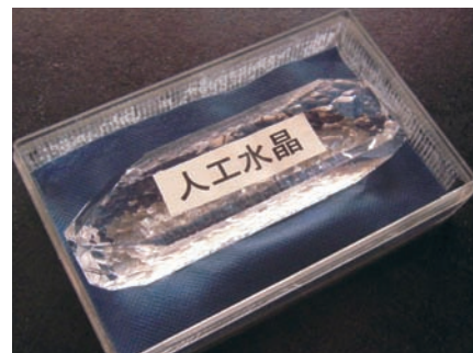
図2 水熱合成法で育成された人工水晶
