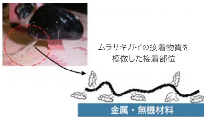
図8: 今回開発したコーティング剤: 理論上は厚みを数10nmまで薄くできるため、接着剤や錆止めコーティングとして利用価値を高められる可能性を秘めている。
