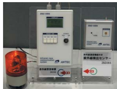
図3 開発した火災検知システム
