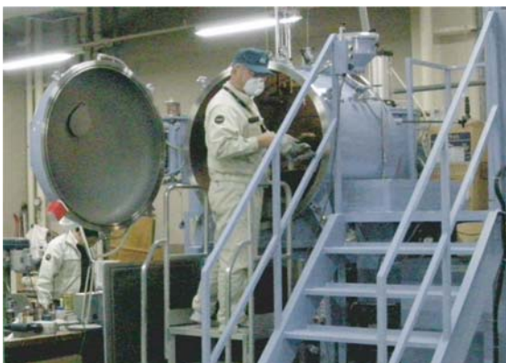
図1 一方向凝固・単結晶凝固炉によるNi基単結晶合金製造の様子
