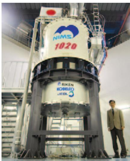
図1 今回開発した1020MHz-NMR装置のうち超伝導磁石の部分。高さ約5m、重さ約15トン。この中に高温超伝導体で作られたコイルが入っています。液体ヘリウムを使って冷却しています。
