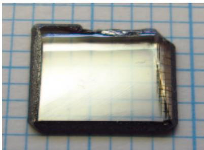
図2 ダイヤモンド単結晶基板上に成長させた高純度・高結晶性CVD単結晶。SiVセンターを含む高純度ダイヤモンド膜の厚さは20 $\mu$ mと厚く、結晶表面の平滑性が高い。
